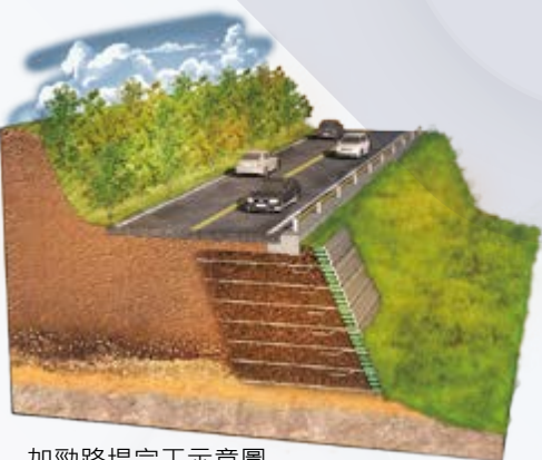
加勁路堤完工示意圖
